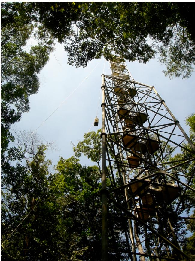
Figure 2. Tour à flux permettant de mesurer les échanges gazeux forêt-atmosphère (site de Paracou en Guyane). Dans la même zone, des capteurs ont été installés au sol pour évaluer les dégagements de GES, notamment de NO<sub>x</sub>. *Crédits photo : Alain Pavé*
