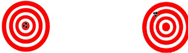
**Figure 2.** Variations d'un résultat de calcul, à gauche, précision et reproductibilité élevées et à droite, précision basse et reproductibilité élevée
